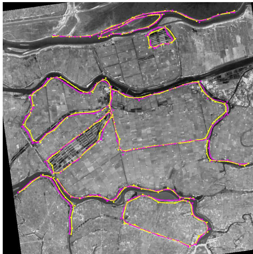
图6-25 第一组粗配准图像的 NURBS拟合曲线在 SPOT-P图像坐标系的迭合( SAR图像 :NURBS 曲线及控制点，黄色； SPOT图像： NURBS曲线及控制点，粉色)
