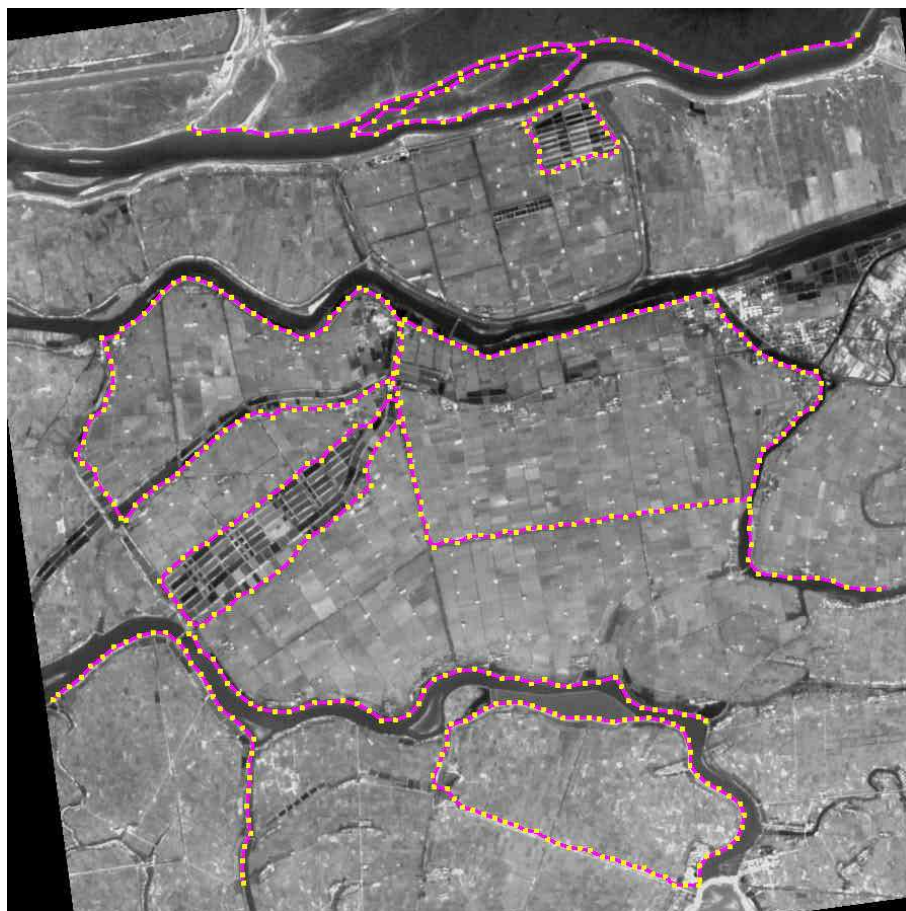
图6-24 第一组数据 SPOT-P图像粗配准部分边缘特征的 NURBS拟合曲线及控制点（896×896: 红色为 NURBS曲线，黄色为控制点）
