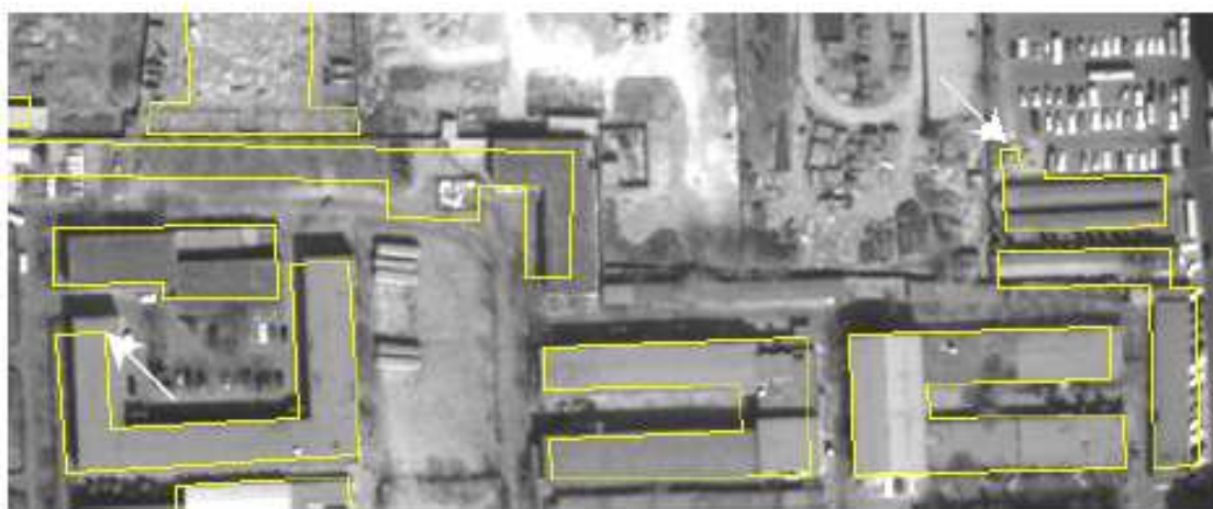
FIG. 2.3 – Superposition d'une carte du bâti (polygones jaunes) avec une image satellitaire. Les flèches blanches pointent des inexactitudes locales de forme de la carte.
