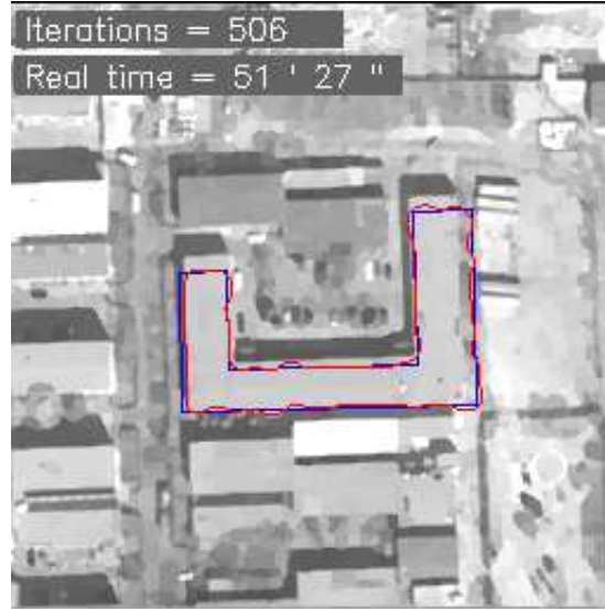
FIG. 6.13 – Expérience avec une image réelle, la forme a priori est le résultat du recalage avec la contrainte de forme classique. La segmentation est effectuée avec le modèle d'attache aux données de Chan et Vese, la contrainte de forme autorisant les variations parallèles et avec correction quadratique \lambda_{para} = 4 , \lambda_{quad} = 0.5 et a = 0.5 .
