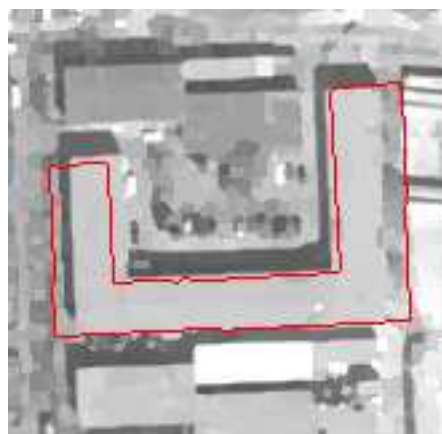
FIG. 5.29 – Convergence finale du contour actif avec une forme a priori erronée
