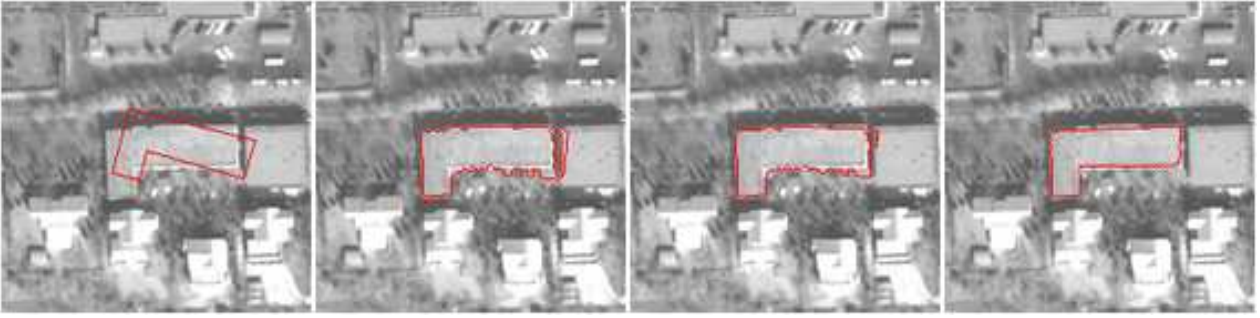
FIG. 5.22 – Segmentation avec une variation spatio-temporelle de la contrainte de forme et le modèle Bayésien ( \lambda_{min} = 27 , \lambda_{max} = 70 , d_0 = 7 ).
