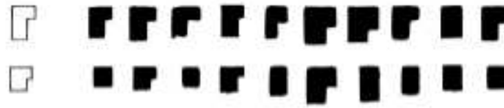
FIG. 2.1 – Erreurs de délinéation des contours : différentes segmentations (en noir) du même objet (vérité terrain en blanc) par plusieurs photo-interpréteurs. Le schéma est extrait de [80].
