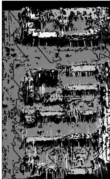
FIG. 3.21 – MNS orthorectifié avec un pas R = 0.65 m et \varepsilon_{corr} = 0.4 .
