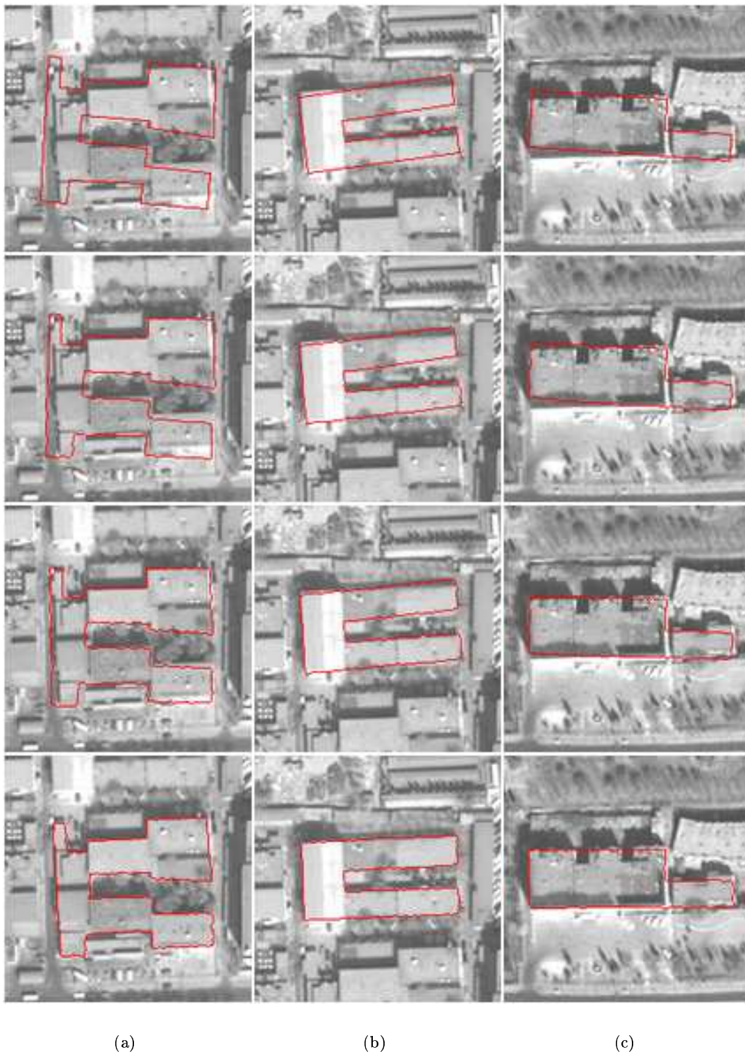
FIG. 5.13 – Sensibilité à l'initialisation : segmentation avec un contour actif basé sur l'information de contour (GVF) et avec contrainte de forme.
